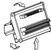
安裝時請先固定一面，再依1號箭頭方向將擴充驅動板導入DIN軌，並請注意底座彈簧是否與DIN軌緊密結合。拆解時請先依2號箭頭方向往上推，再依3號箭頭方向往外拉出即可順利拆解。
