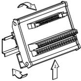
安裝時請先固定一面，再依1號箭頭方向將擴充驅動板導入DIN軌，並請注意底座彈簧是否與DIN軌緊密結合。拆解時請先依2號箭頭方向往上推，再依3號箭頭方向往外拉出即可順利拆解。
