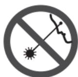
No dirija el rayo láser hacia personas o animales y no mire al rayo láser usted mismo. Esta herramienta produce radiación láser de clase 2 y cumple con las normas 21 CFR 1040.10 y 1040.11, excepto por las desviaciones conformes al Aviso sobre láser No. 50, de fecha 24 de junio de 2007. Esto puede causar ceguera en las personas.
