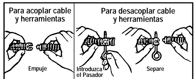
Figura 8 – El acoplamiento y desacoplamiento de las varillas y herramientas
