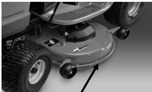
Coque d'unité de coupe estampée protégée par armure
